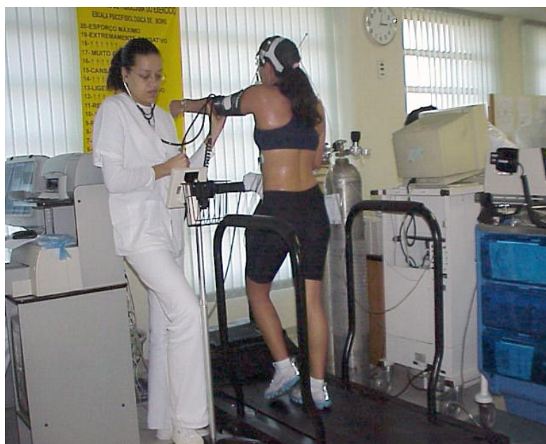
Figura 4 – Indivíduo sendo submetido ao teste ergoespirométrico por meio de Analisador metabólico de gases computadorizado respiração-a-respiração (CPX/D, MedGraphics, Saint Paul, MN, [EUA]) .
